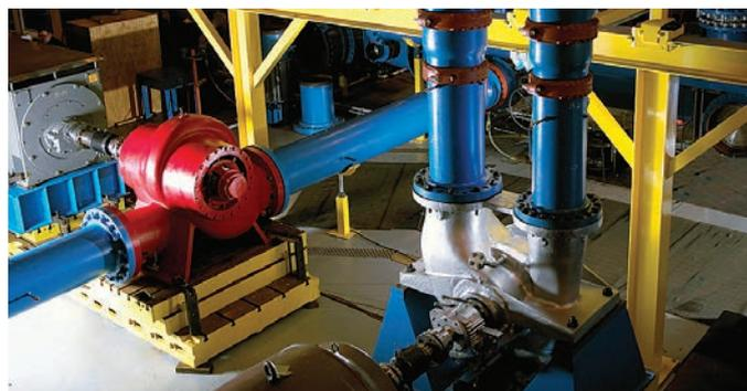
Один из стендов для испытаний насосов мощностью до 8000 л.с./6000 кВт.
