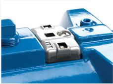
Das Herz des *i-FRAME*, das *i-ALERT*-Zustandsüberwachungsgerät, misst kontinuierlich Vibrationen und Temperatur am Drucklager und zeigt automatisch an, wenn voreingestellte Vibrations- oder
