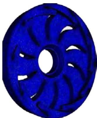
Modelliert mit einem Netz von über 2 Millionen Elementen
