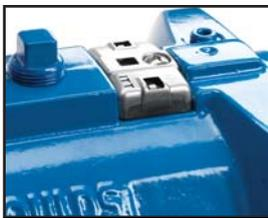
Sendo o cerne do *i*-FRAME, *i*-ALERT a unidade do monitor de condição mede continuamente a vibração e a temperatura no mancal de impulso e indica automaticamente quando os níveis predefinidos de vibração e temperatura são excedidos, de modo que alterações possam ser feitas no processo ou na máquina antes que uma falha chegue a ocorrer.
