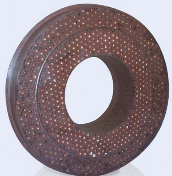
Опция – футеровка бронедиска из натурального каучука армированного керамикой (CRM) Для 10 x10 –28 SRL-XT
