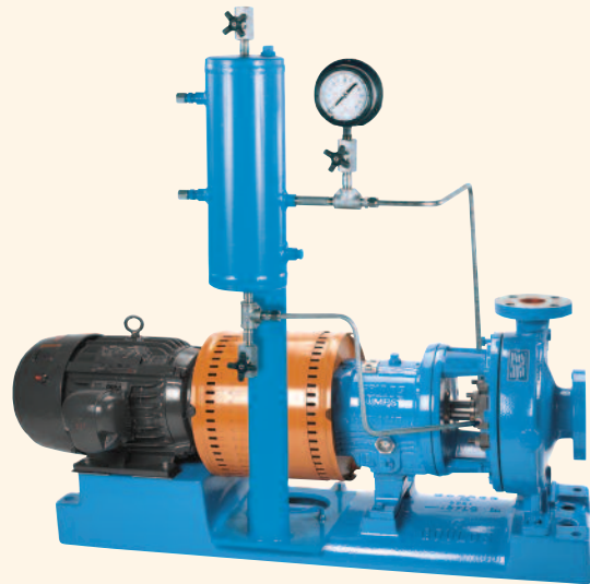
PLANO CPI 7353 Circulação pressurizada lubrifica as faces de vedação duplas.
