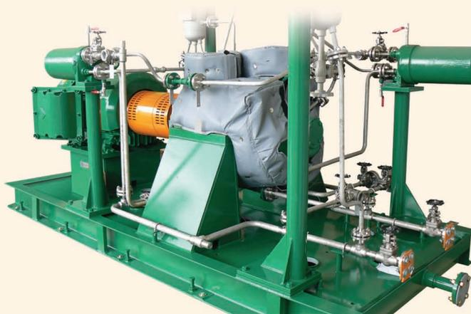
As bombas de processo radialmente divididas entre rolamentos Modelo 3640 da Goulds foram projetadas para proporcionar uma operação tranquila e confiável e atender aos mais rigorosos requisitos das normas API-610/ISO 13709 a fim de assegurar uma vida útil prolongada.
