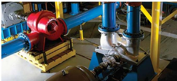
Стенды для испытаний насосов мощностью до 8000 л.с./6000 кВт
