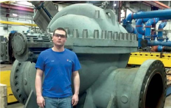
НПЗ в Бразилии. Насос нефтепровода 30x36-32 600 на давление 42 бара мощностью 3500 Л.С. (2600 кВт)
