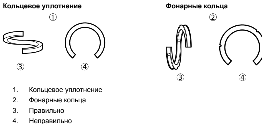
Рис. 50: Уплотнительные кольца и фонарные кольца
