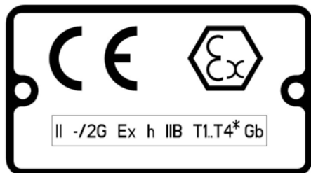
Kuva 1: Tyypillinen ATEX-pumpun tyypikilpi
