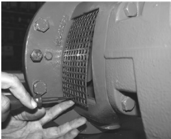
Figura 8: Desmontaje de la pantalla de la linterna del motor
