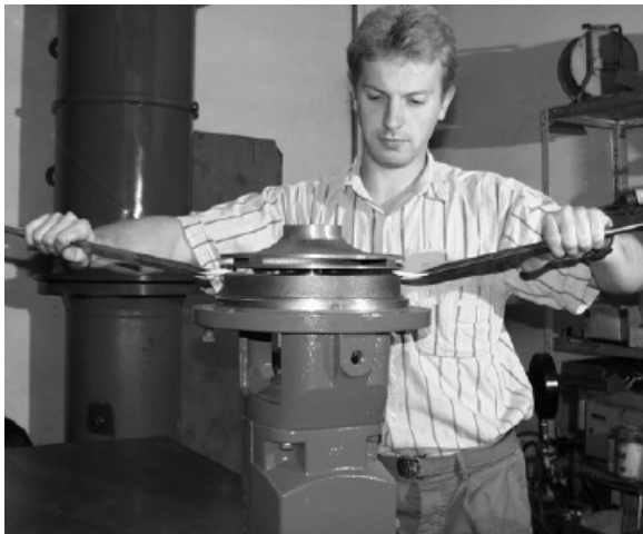
Figure 9: Placer en position verticale pour éviter le basculement
