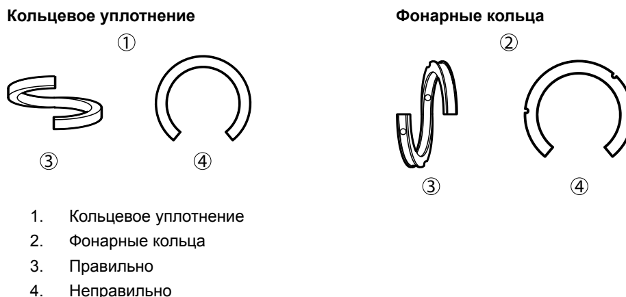
Рис. 49: Уплотнительные кольца и фонарные кольца
