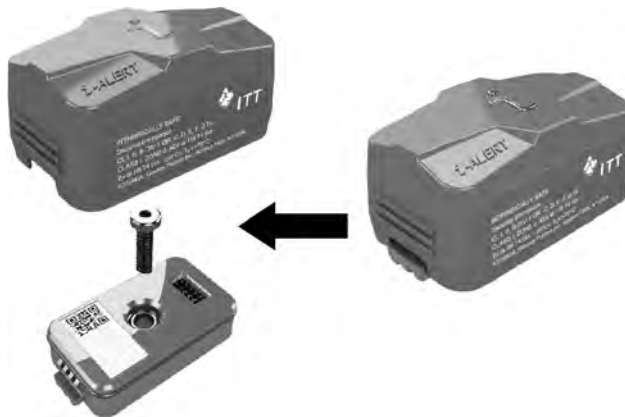
Figura 49: Desconecte la batería del sensor cuando cierre la bomba durante un período de tiempo prolongado
