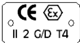
Figura 1: Placa de identificación típica de una bomba ATEX
