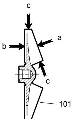
**No de graphique 84: Zones de contrôle d'usure sur le rotor 3196 CV 3198.**
