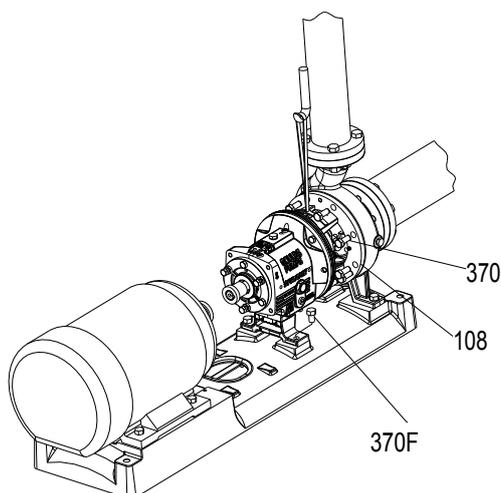
**No de graphique 50: Retrait de l'ensemble d'entraînement de la roue (avec adaptateur en C)**
