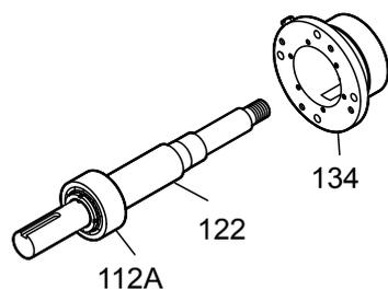
10. Retirez l'écrou autobloquant de roulement (136), la rondelle-frein de roulement (382) et le roulement externe (112A).
