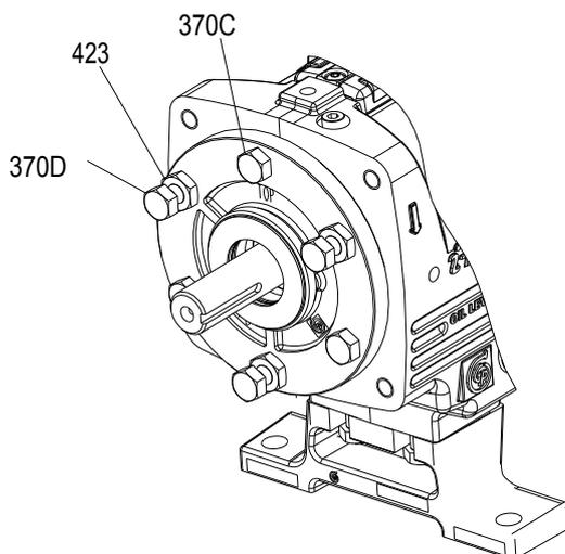
**No de graphique 138: Desserrer les vis de bridage et les vis de déblocage sur le boîtier de roulement**
