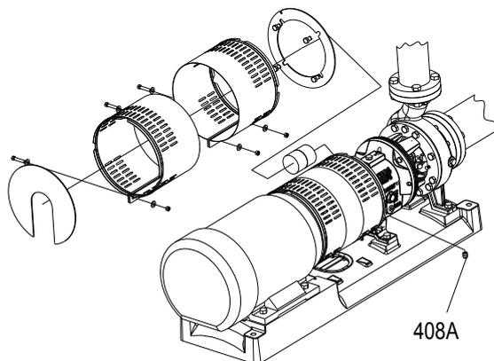
**No de graphique 49: Retrait de l'ensemble d'entraînement de la roue (cadre de roulement lubrifié à l'huile)**
