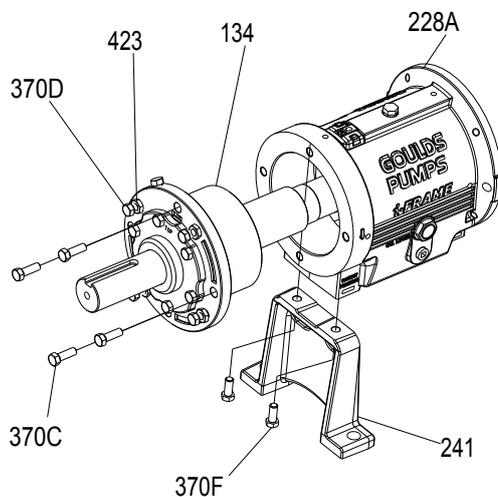
2. Enlever les vis de blocage (370C) et desserrer les contre-écrous (423).
