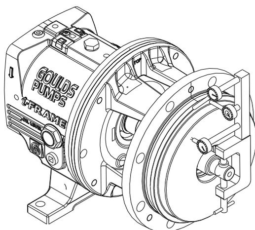
**No de graphique 128: Contrôler l'excentricité du couvercle de la chambre du joint**
