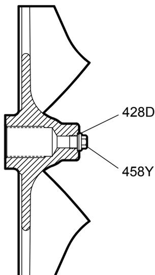
2. Vaporiser de l'huile par l'orifice du bouchon dans la cavité qui se trouve à l'extrémité de l'arbre et laisser pénétrer pendant 15 minutes.
