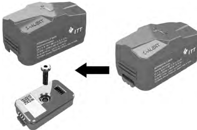
Figura 52: Desconecte la batería del sensor cuando cierre la bomba durante un período de tiempo prolongado
