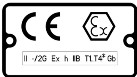
Rysunek 8: Typowa tabliczka znamionowa Ex
