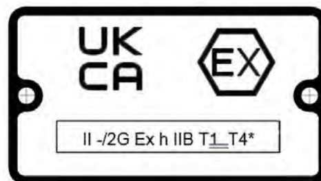
Rysunek 9: Typowa tabliczka znamionowa Ex UKCA
