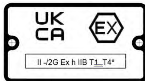
Rysunek 2: Typowa tabliczka znamionowa Ex UKCA
