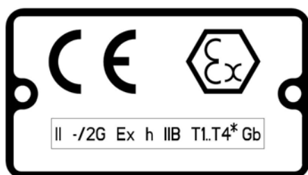
Рис. 8: Типовая заводская табличка ATEX
