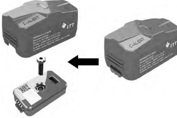
Şekil 47: Pompayı uzun süre kapatırken pili sensörden ayırın
