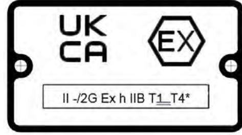
Şekil 2: Tipik UKCA Ex isim levhası
