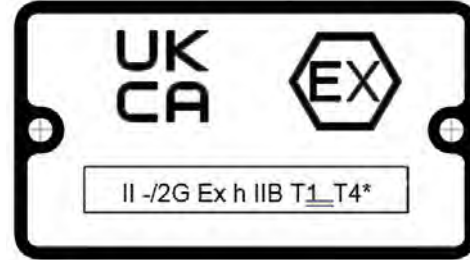
Şekil 16: Tipik UKCA Ex isim levhası
