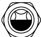
Figura 19: Visor del nivel de aceite
