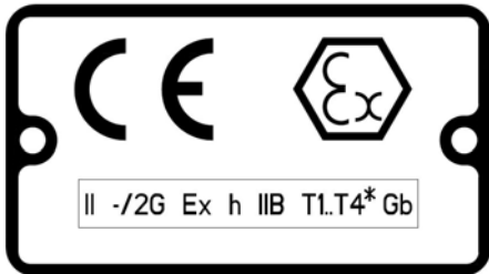
Figura 13: placa de informações típica da bomba ATEX
