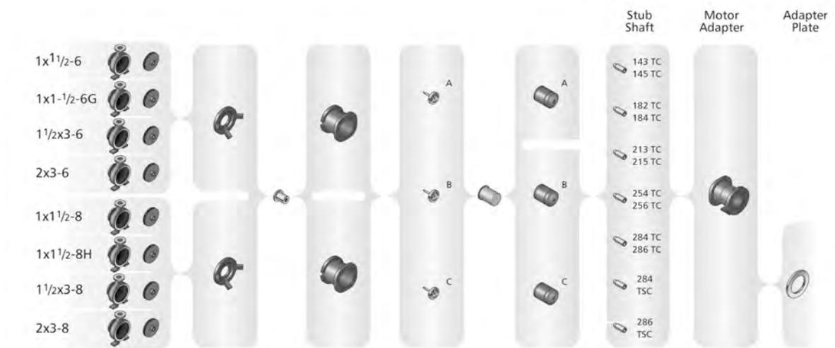
**Figura 35: Acoplamiento corto 3296 EZMAG**
