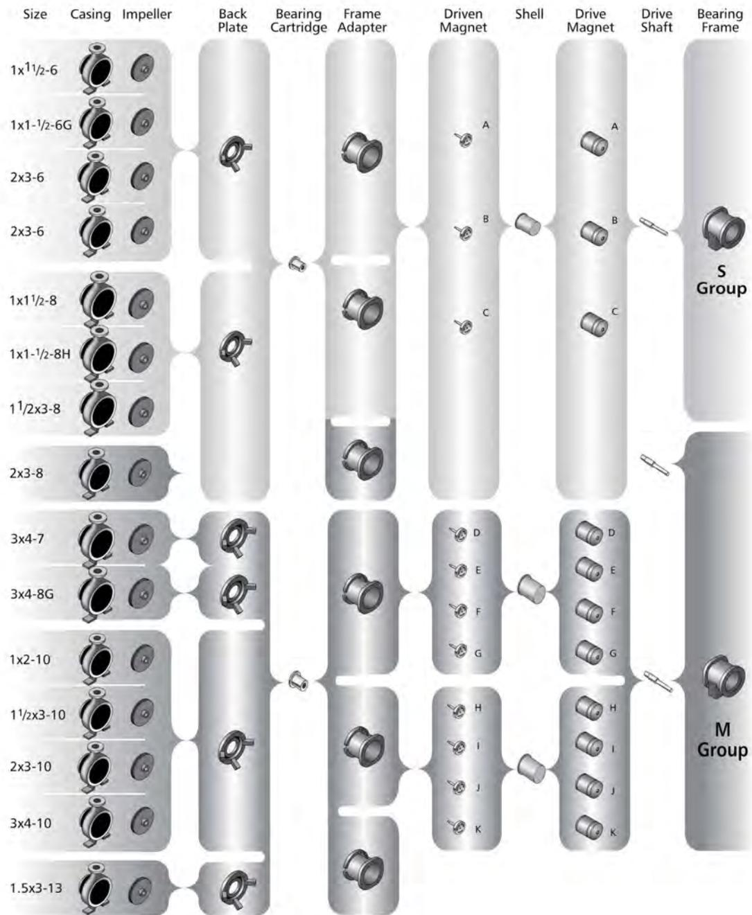
Figura 34: Montaje en bastidor 3296 EZMAG
