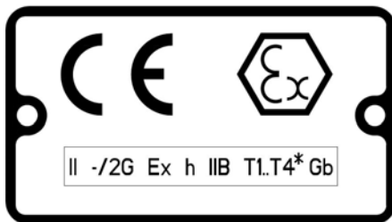
No de graphique 7: Plaque signalétique typique de la pompe ATEX
