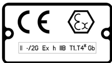
Figura 7: Placa de identificación típica de una bomba ATEX
