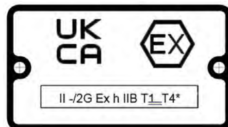
Figure 15: Plaque signalétique UKCA Ex typique
