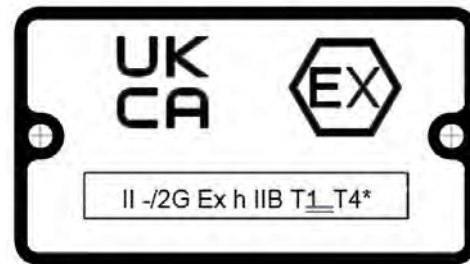
Figure 2: Plaque signalétique UKCA Ex typique
