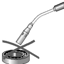
Figura 36: No utilice un soplete para calentar los rodamientos.
