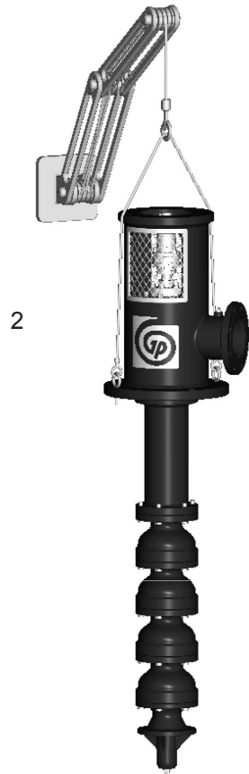
图 1: VIT 从水平提升到垂直位置 (对于长度最大为 15 英尺 [4.6 米] 的泵)
