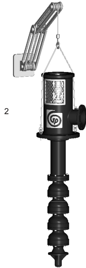
Figure 1: Groupe VIT levé de la position horizontale à la position verticale (pour les pompes jusqu'à 15 pieds [4,6 mètres] de long)
