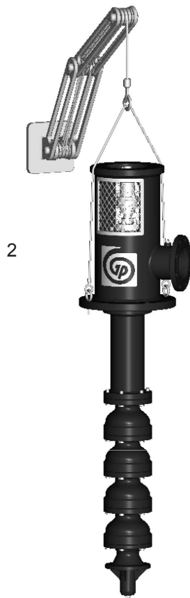
Abbildung 1: VIT aus der horizontalen in die vertikale Position gehoben (für Pumpen bis 4,6 m (15 ft) Länge)
