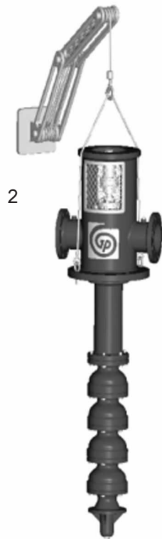
Figura 1: VIC içado de horizontal para vertical (para bombas até 15 pés [4,6 metros] de comprimento)
