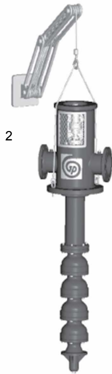
图 1: VIC 从水平提升到垂直位置 (对于长度最大为 15 英尺 [4.6 米] 的泵)
