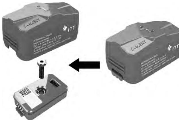
Figura 48: Desconecte la batería del sensor cuando cierre la bomba durante un período de tiempo prolongado
