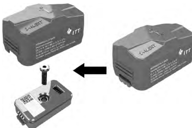
Rysunek 37: Odłączyć akumulator od czujnika podczas wyłączania pompy na dłuższy czas
