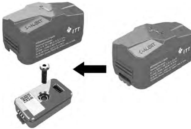
Figura 47: Desconecte la batería del sensor cuando cierre la bomba durante un período de tiempo prolongado
